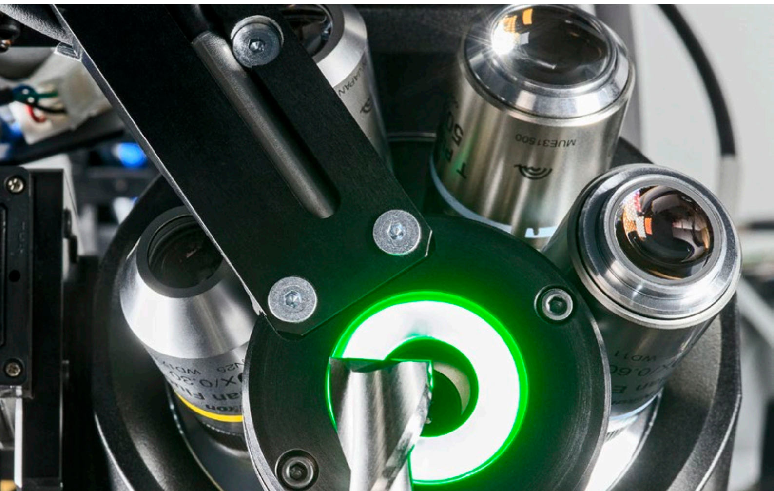
カメラの水平方向「0度」位置合わせ
