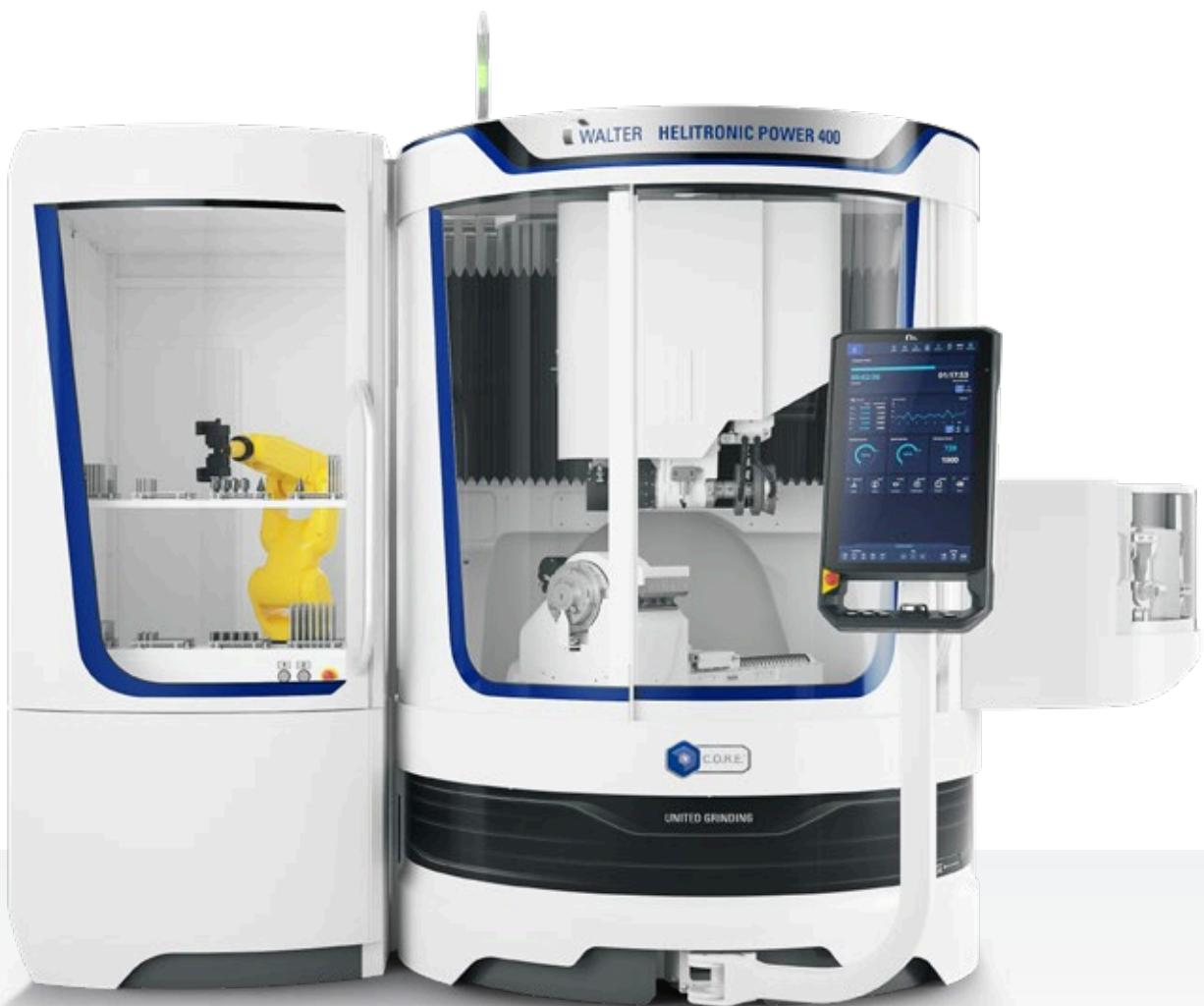
HELITRONIC POWER 400 右:砥石交換装置
