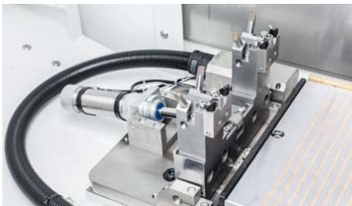
**Profilatore ribaltabile** per la ravnatura fascia e fianco mola e profili. Grazie all'azionamento pneumatico, si evita ogni possibilità di collisione tra la mola, il suo carter di protezione ed il ravnatore.
