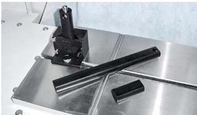
**Portadiamante** con inserti intercambiabili (90, 150, 300 mm) per una efficiente ravnatura della fascia e dei fianchi mola, nonché per la calibrazione.
