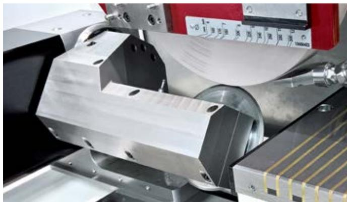
**Profilatore basculante PA-T130**, posizionato a sinistra del piano magnetico, per la realizzazione di profili ad elevatissima precisione e cambio utensile rapido. Messa a punto automatica dei rulli diamantati (profondità profilo fino a 30 mm).
