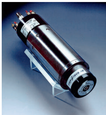
La broche HVC 140 a été la première broche à grande vitesse fabriquée en série par STEP TEC. Avec une vitesse de 42 000 tr/min sur des paliers hybrides en céramique et en combinaison avec l'accélération de 1 g sur les axes du HSM 700, il a permis pour la première fois en 1996 de réaliser un fraisage industriel à grande vitesse
