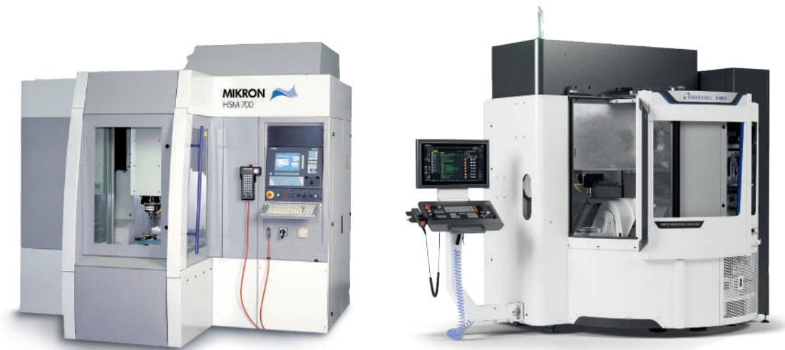
De la révolution à l'évolution, le HSM 700 lancé en 1996 a redéfini le fraisage industriel à grande vitesse, tandis que la série MIKRON MILL X (U) actuelle représente trente ans d'innovation continue en matière de précision, de dynamique et de connectivité, pour l'usinage 3 axes et 5 axes simultanés
