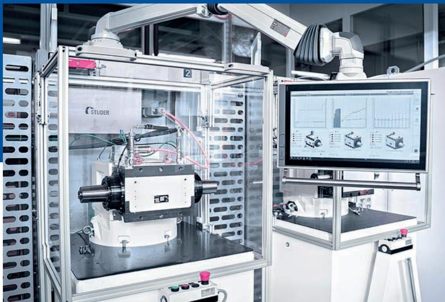
*Le rinnovate postazioni di collaudo dei mandrini sono isolate dalle vibrazioni, possono essere azionate singolarmente e sono dotate di sistemi di sensori di precisione*
