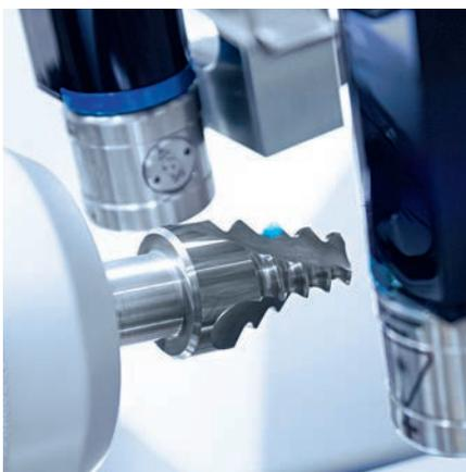
*Il laser misura una fresa con profilo ad abete per l'industria delle turbine*
