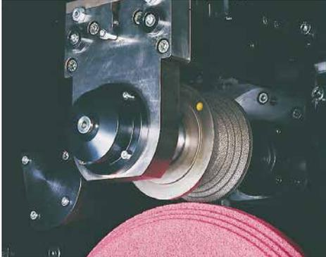
**CD-Abrihtgerät** auf dem Schleifkopf, Einspindelausführung (V-Achse)
